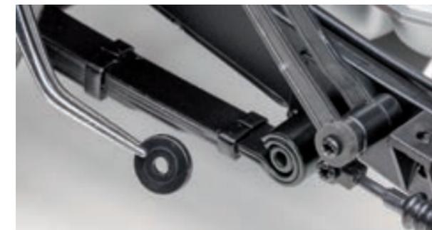
**Шаг 17.** При помощи винта 2,3×5 (IM) и специальной (большой) шайбы закрепите задний конец рессоры на оси кронштейна левого лонжерона рамы.
