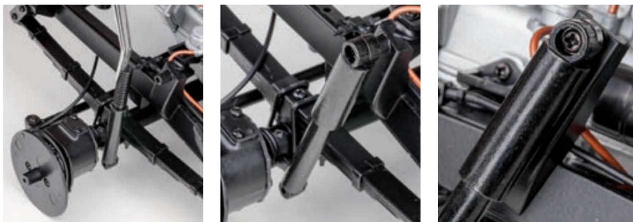
**Шаг 16.** Поверх штока амортизатора установите пружину и кожух амортизатора. Закрепите верхнюю часть кожуха амортизатора на кронштейне рамы винтом 2,3×4 (PM).
