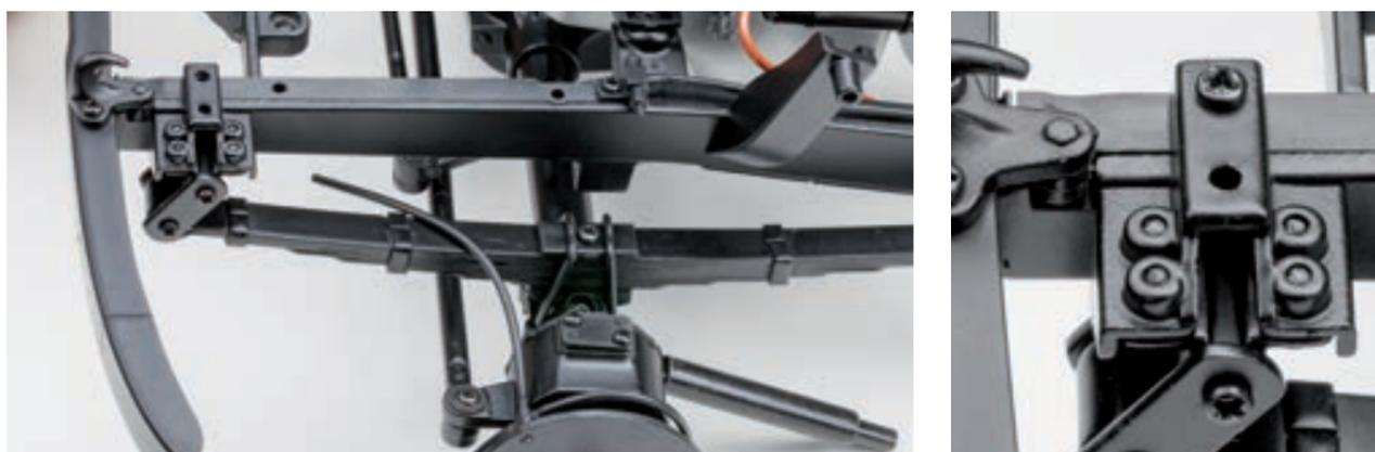
**Шаг 15.** Установите задний конец рессоры на ось заднего кронштейна рамы. Разместите опору переднего кронштейна рессоры поверх левого лонжерона рамы модели. Закрепите опору на раме винтом 2,0×4 (EP).
