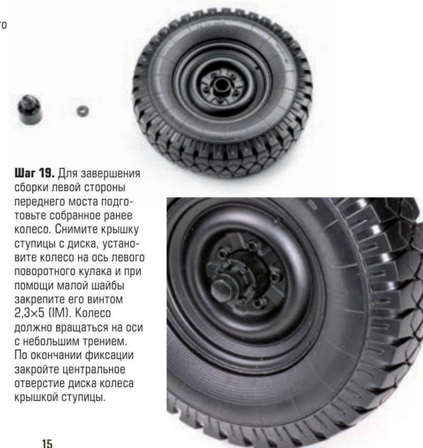
**Шаг 19.** Для завершения сборки левой стороны переднего моста подготовьте собранное ранее колесо. Снимите крышку ступицы с диска, установите колесо на ось левого поворотного кулака и при помощи малой шайбы закрепите его винтом 2,3×5 (IM). Колесо должно вращаться на оси с небольшим трением. По окончании фиксации закройте центральное отверстие диска колеса крышкой ступицы.
