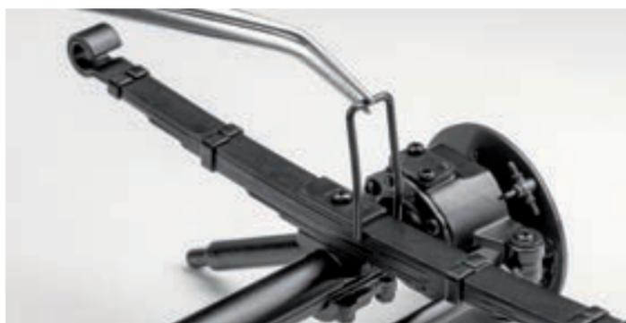
**Шаг 9.** Установите две стремянки поверх рессоры. После монтажа стремянки должны быть изогнуты к центру рессоры. Закрепите стремянки в отверстиях площадки рессоры на кожухе полуоси. Стремлянки должны держаться в отверстиях за счет трения. Для дополнительной фиксации воспользуйтесь клеем.
