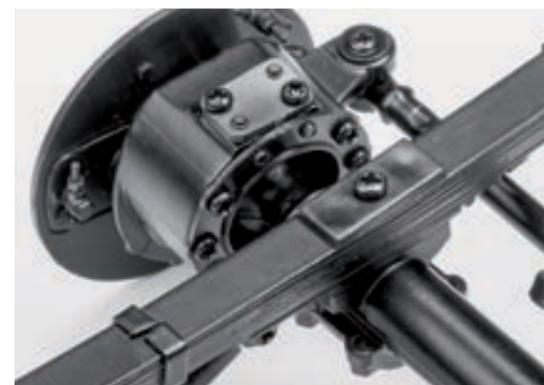
**Шаг 8.** Установите рессору на площадке левого кожуха полуоси переднего моста. Кронштейн рессоры с опорой должен располагаться в передней части рессоры. Зафиксируйте рессору на кожухе моста винтом 2,0×6 (ОМ) сквозь накладку в средней части рессоры.
