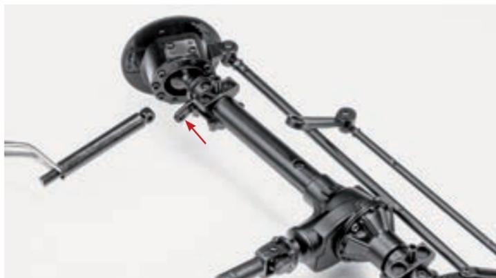
**Шаг 7.** При помощи винта 2,0×5 (НМ) закрепите корпус амортизатора на кронштейне кожуха левой полуоси переднего моста. Амортизатор крепится с внешней стороны кронштейна кожуха.
