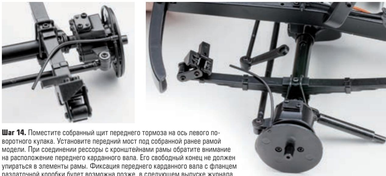
**Шаг 14.** Поместите собранный щит переднего тормоза на ось левого поворотного кулака. Установите передний мост под собранной ранее рамой модели. При соединении рессоры с кронштейнами рамы обратите внимание на расположение переднего карданного вала. Его свободный конец не должен упираться в элементы рамы. Фиксация переднего карданного вала с фланцем раздаточной коробки будет возможна позже, в следующем выпуске журнала.
