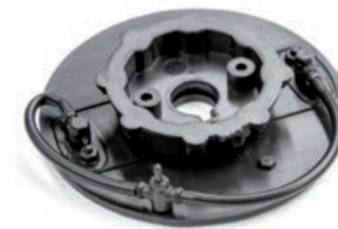
**Шаг 12.** На заднем крепежном штифте тормозного тройника установите трубку заднего тормозного цилиндра длиной 35 мм. Второй конец трубки закрепите на штуцере заднего тормозного цилиндра переднего тормоза.
