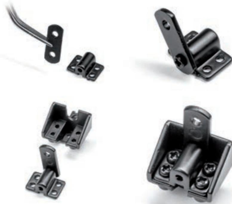
**Шаг 3.** Прикрепите втулку рессоры к свободному концу щеки серьги рессоры. Для фиксации детали используйте винт 2,0×5 (IP).
